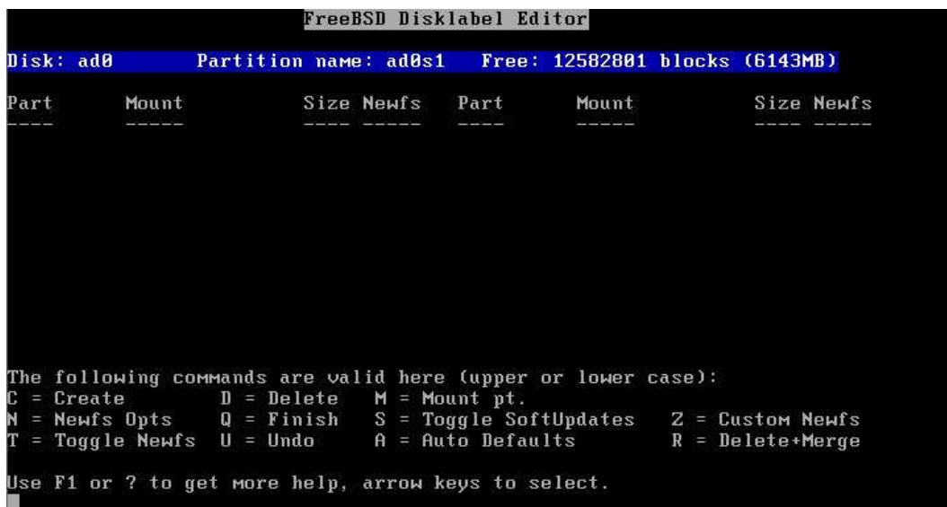
รูปที่ 10 แสดงหน้าจอของการสร้าง Mount Point
