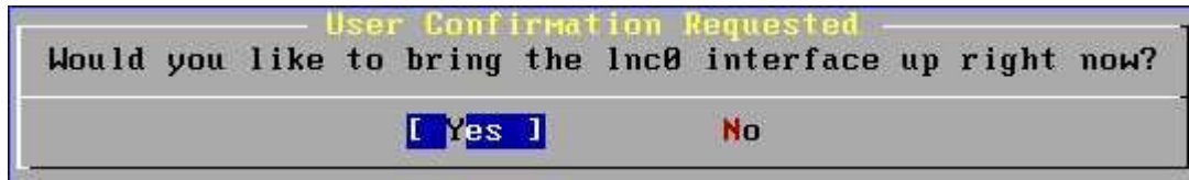
รูปที่ 24 แสดงการถามยืนยันให้ LAN Card ทำงานหรือไม่
