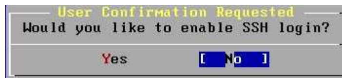
รูปที่ 27 แสดงหน้าจอการยืนยันให้ sshd Service ทำงานหรือไม่
