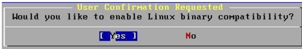
รูปที่ 40 แสดงหน้าจอยืนยันการยอมรับ Package ของ LINUX ให้ลงบน FreeBSD ได้
