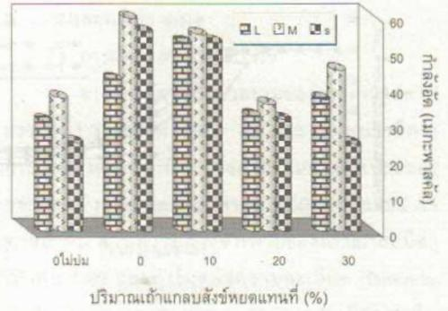
รูปที่ 8 กำลังอัดของคอนกรีตมวลรวมข้ามขนาดของกรวดทะเลสาบสงขลา
