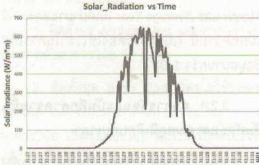
รูปที่ 8 กราฟแสดงค่าความเข้มของแสงอาทิตย์เทียบกับเวลา
